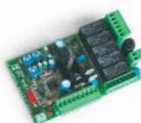
Плата блока управления (стандартная) двумя приводами с разъемом для установки радиоприемника CAME
